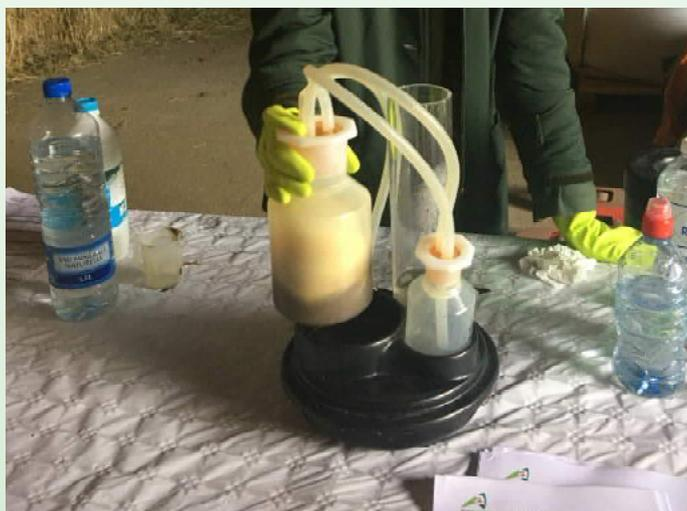
Analyse d'un lisier au quantofix
