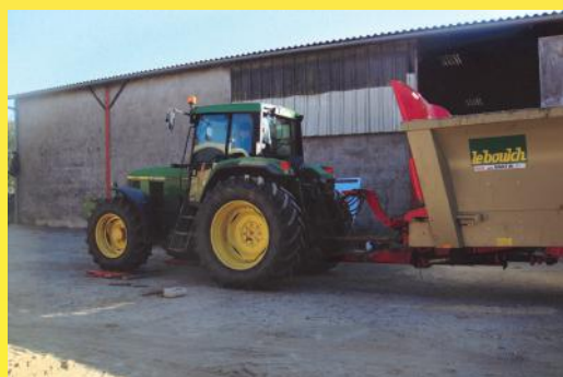
Pesée d'un épandeur permettant de connaître la quantité de fumier épandue
