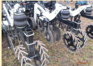
L'outil se compose d'un disque ouvreuse avec 2 roues de jauge, d'étoiles chasse débris, de la dent accompagnée de 2 disques billonneurs et afin d'un rouleau émietteur.
