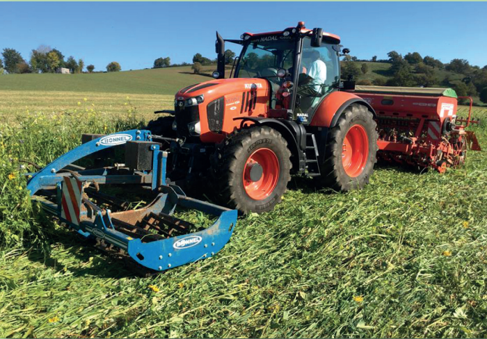
Photo ci-contre : un rouleau hacheur à l'avant, et un semoir direct à l'arrière : cette technique est testée, en comparaison avec les autres modalités.
